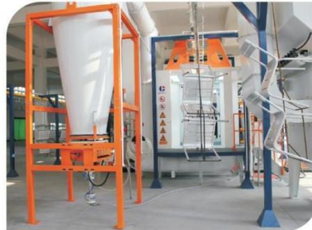
1套 双层复合三明治喷室，工程塑料为德国品牌，工程塑料板厚度为6mm 及双层厚度120mm。（中空）
