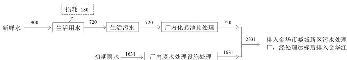
图 3.5-1 项目水平衡图（单位：t/a）
